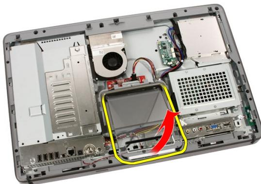
5. Faites glisser le cache du socle inclinable à travers le socle et retirez le cache de socle inclinable arrière de l'ordinateur.
