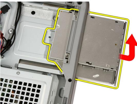
6. Soulevez le cadre de l'unité optique pour l'utiliser sur l'unité optique de remplacement.
