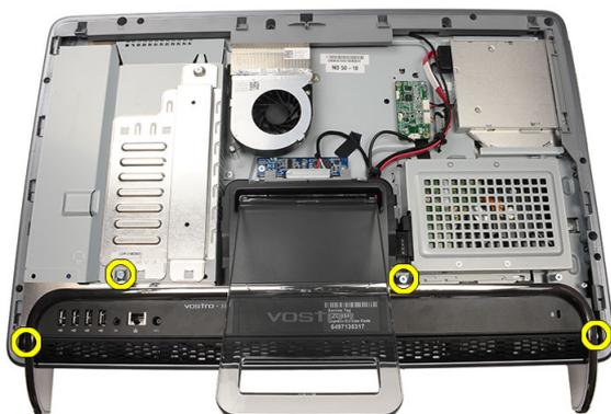
4. Repliez le socle inclinable arrière aussi loin que possible puis soulevez le socle avant hors de l'ordinateur.
