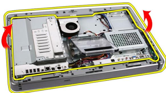
7. Au besoin, soulevez délicatement le cadre central, près des ports sur la droite de l'ordinateur. Les languettes en bas du cadre central se fixent ici au châssis.
