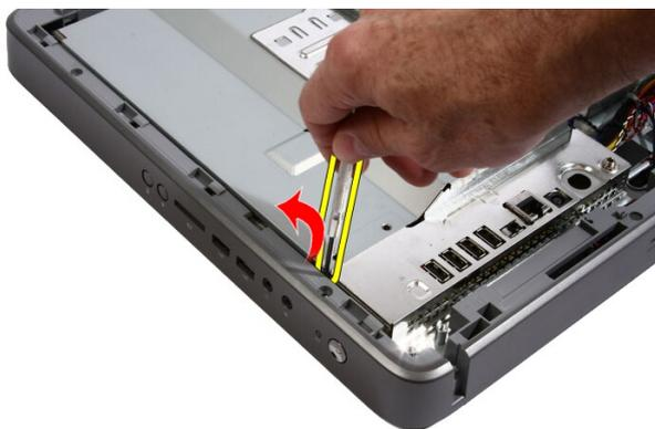
8. Inclinez le cadre selon un angle permettant de dégager les languettes du châssis.
